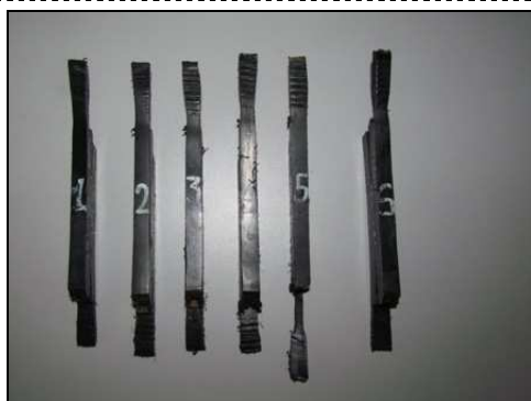
Fot. 27, 28 Próbki LB/47/2020 po badaniu korozji naprężeniowej
