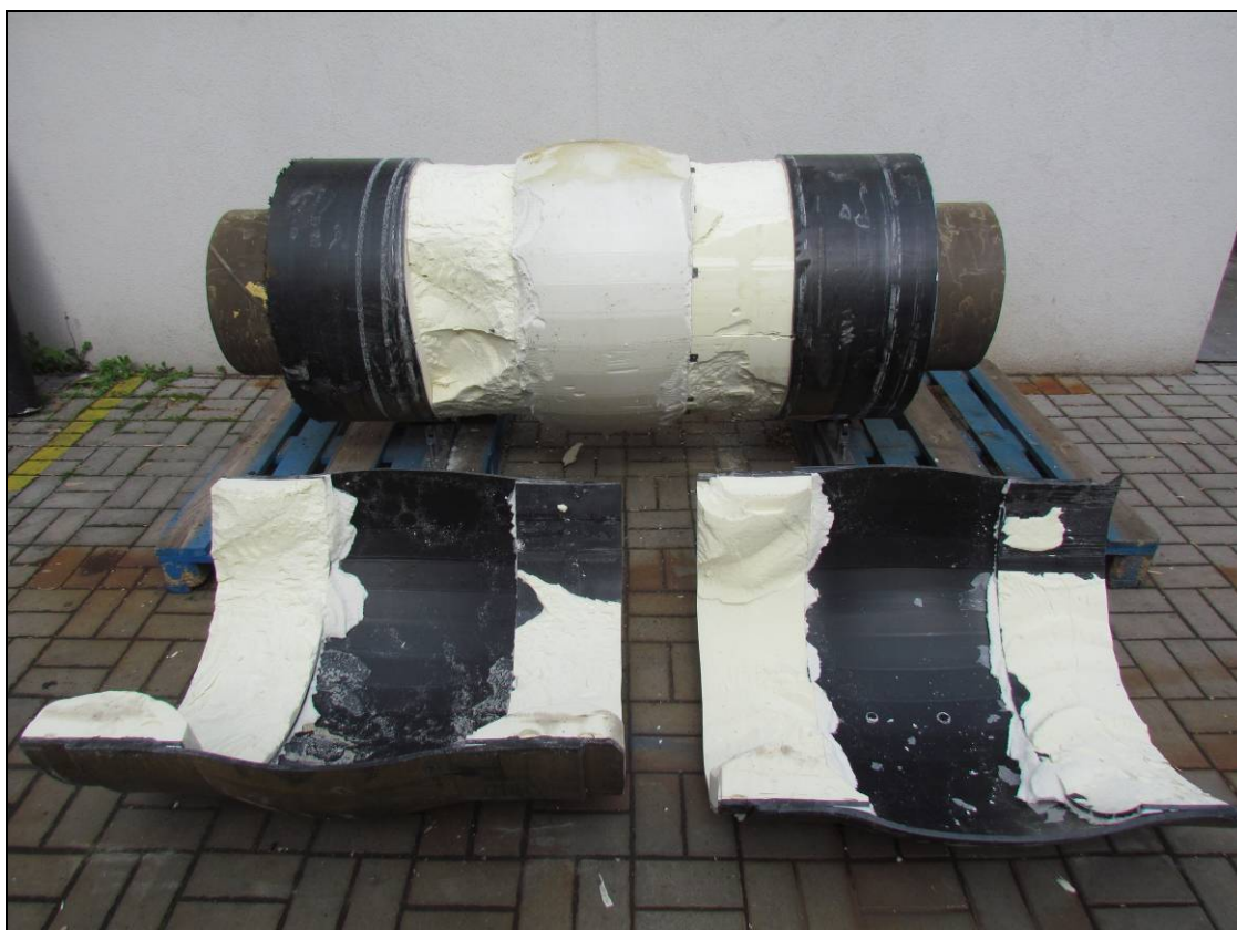
Fot. 11 ÷ 12 Próbką LB/47/2020 po badaniu szczelności
