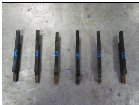
Fot. 25, 26 Próbki LB/47/2020 przed badaniem korozji naprężeniowej
