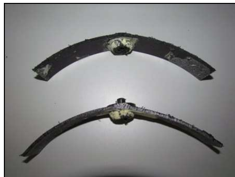
Fot. 13, 14 Próbka LB/42/2020 przed próbą zginania korków wgrzewanych
