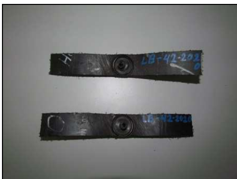
Fot. 15, 16 Próbka LB/42/2020 po próbie zginania korków wgrzewanych
