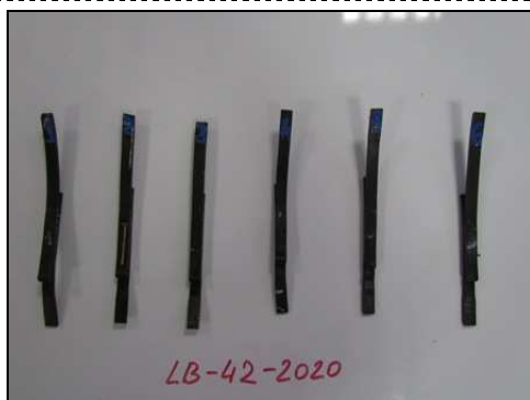
Fot. 23, 24 Próbki LB/42/2020 po badaniu korozji naprężeniowej
