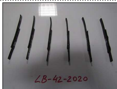
Fot. 21, 22 Próbki LB/42/2020 przed badaniem korozji naprężeniowej
