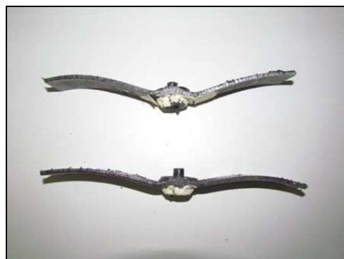
Fot. 15, 16 Próbka LB/42/2020 po próbie zginania korków wgrzewanych
