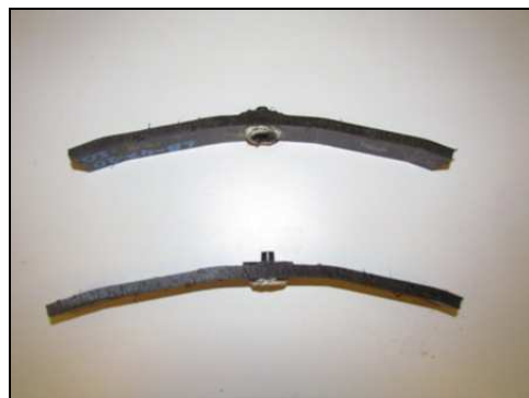
Fot. 17, 18 Próbka LB/47/2020 przed próbą zginania korków wgrzewanych
