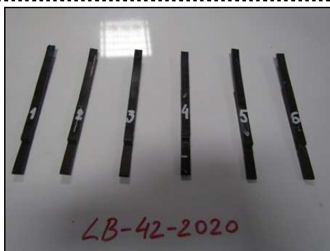
Fot. 21, 22 Próbki LB/42/2020 przed badaniem korozji naprężeniowej
