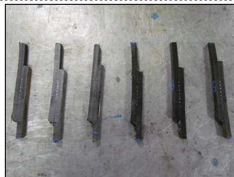
Fot. 25, 26 Próbki LB/47/2020 przed badaniem korozji naprężeniowej
