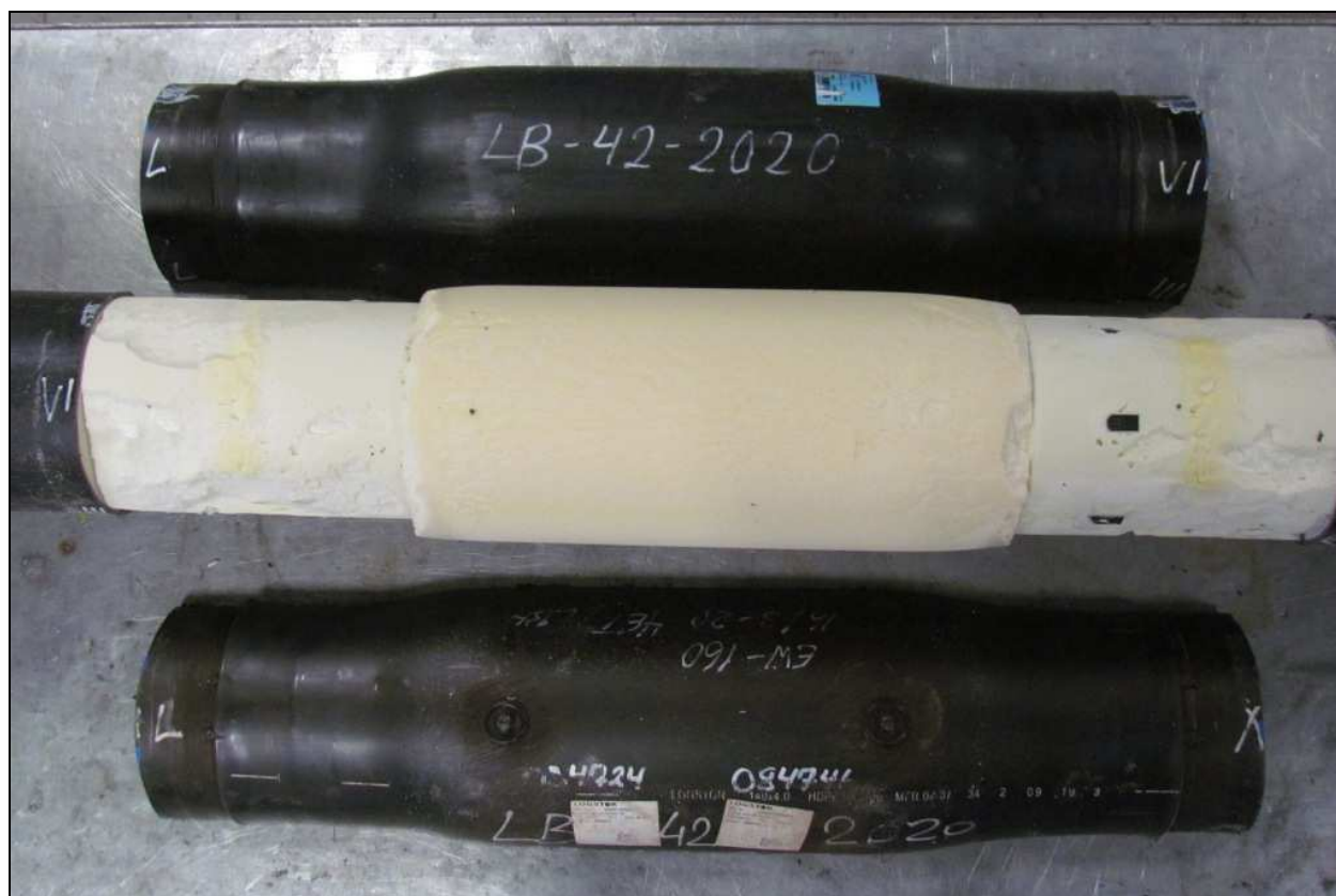
Fot. 5÷6 Próbka LB/42/2020 po badaniu szczelności po rozcięciu
