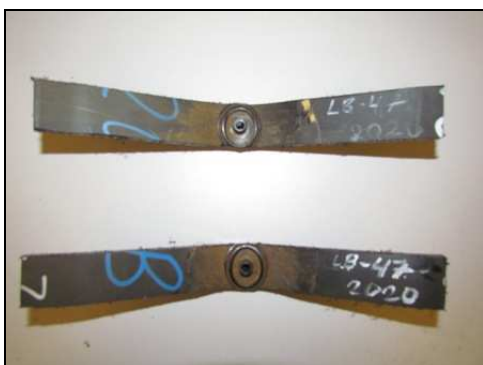
Fot. 19, 20 Próbka LB/47/2020 po próbie zginania korków wgrzewanych
