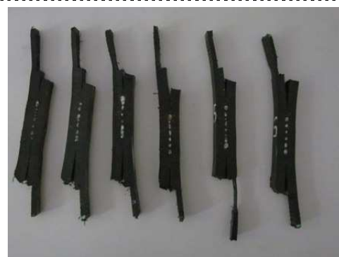
Fot. 27, 28 Próbki LB/47/2020 po badaniu korozji naprężeniowej
