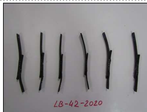
Fot. 23, 24 Próbki LB/42/2020 po badaniu korozji naprężeniowej
