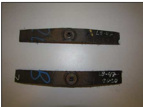
Fot. 17, 18 Próbka LB/47/2020 przed próbą zginania korków wgrzewanych
