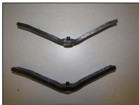
Fot. 19, 20 Próbka LB/47/2020 po próbie zginania korków wgrzewanych
