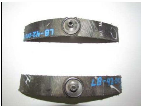
Fot. 13, 14 Próbka LB/42/2020 przed próbą zginania korków wgrzewanych
